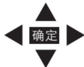
：进入(电视)界面后，可通过此按钮进行上下左右移动光标，选择命令。按下(确定)按钮，执行选中命令。
