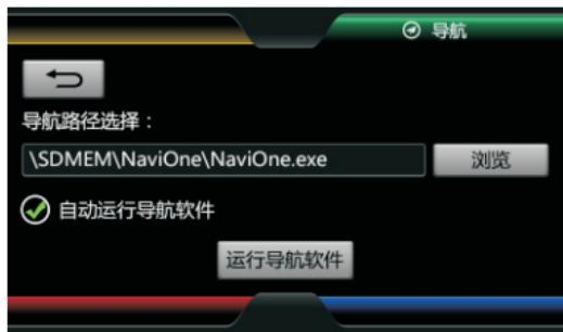
(运行导航软件)：点击此按键运行所选路径的地图软件。
