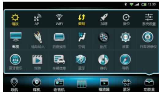
(行车记录)或(电视)：当在设置页中设定为DVR时，点击主界面上的(行车记录仪)图标进入行车记录仪界面，否则点击时会弹出“请安装行车记录仪设备，并在设置页中切换到行车记录仪”话框。电视操作与行车记录仪操作一样。
